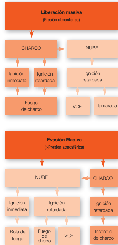
FIG 5 Interrelación de los tipos de escenario con las formas de contención e ignición
