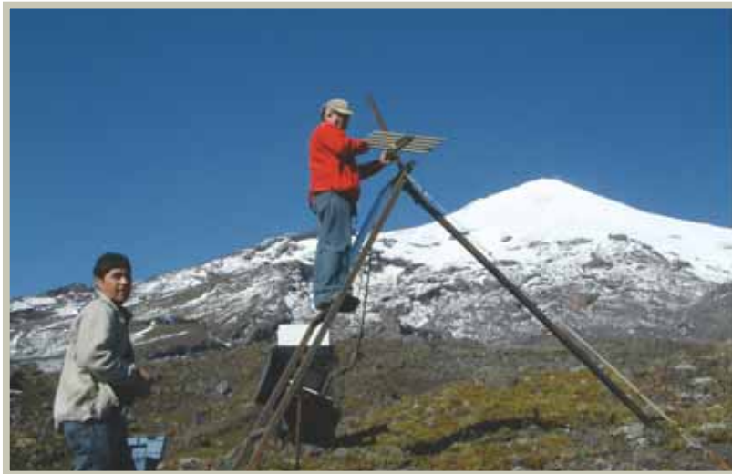
Colocación de una estación sísmica en la base del volcán Villarrica (Chile). Foto A. Linares.
