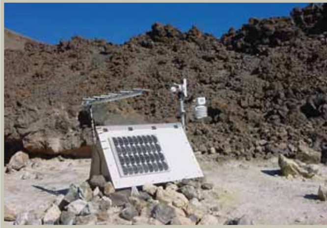
Estación automática del ITER para la medida de la emisión difusa de gases en el Teide. Foto R. Ortiz.
