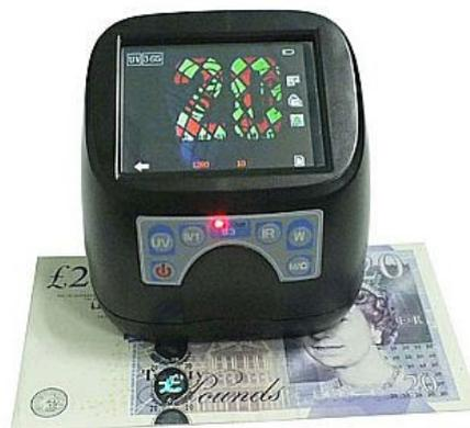
Otra buena aportación es la realizada por la casa Aco Electronics. Su equipo de verificación MDV-05 consta de dos lupas manuales: la de mayor tamaño, dotada de hasta siete fuentes de luz, incluyendo leds de luz blanca, UV e infrarroja y con capacidad de magnificación de 10 aumentos, carga rápida mediante puerto usb; la más pequeña es un visualizador de características retrorreflectantes, como el que usa ·M en su laminado "confirm".
