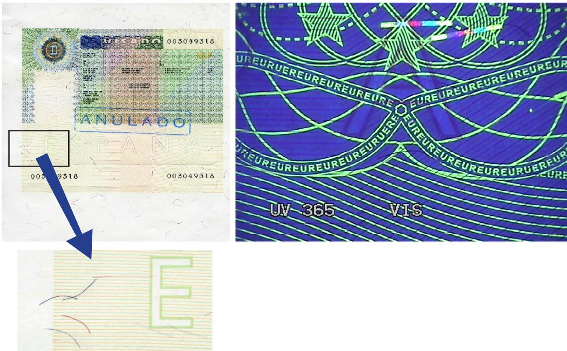
Visado Schengen, modelo 2011 pegado sobre su hoja original, ampliación de zona con fibrillas visibles y tres detalles al iluminarlo con luz UV a 365nm. Las fibrillas que se ven sobre el original con luz natural no reaccionan a la luz UV, las que sí lo hacen no se pueden apreciar con luz natural. Fibrillas UV con 5 tonos.
