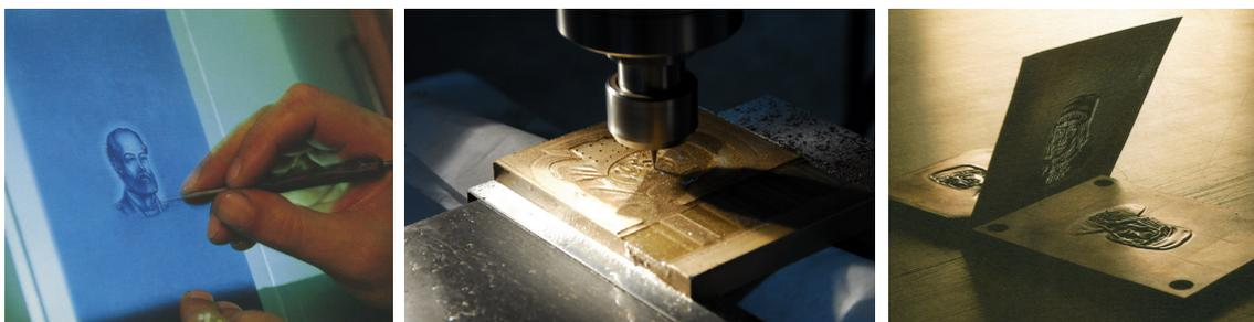
A la izquierda, preparación de un molde de cera; en el centro, troquelado con buril electrónico; a la derecha troquelados en alto y bajo relieve y tela hincada
