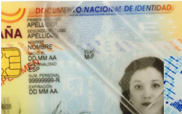
Motivo codificado y posición correcta de la lupa decodificadora para leerlo. La posición del kinegrama sobre el motivo codificado no facilita la visualización del mismo.
