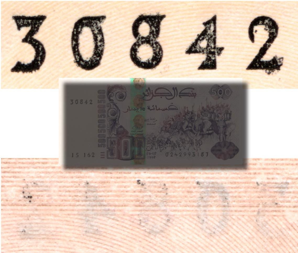
Arriba, anverso y reverso, respectivamente, de la numeración tipográfica obrante en un billete argelino de 500 dinares. Imagen con luz cenital tomada con escáner a 1200ppp, no se aprecia las zonas de impacto sólo el entintado.
