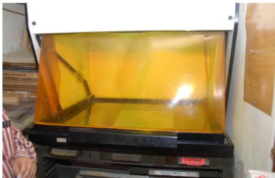
Colocación del fotolito sobre la plancha fotosensible.
