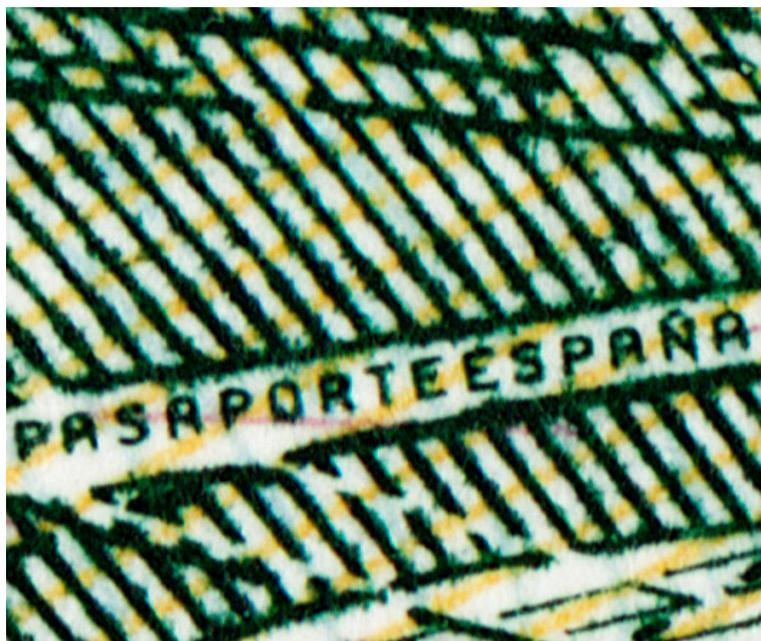
Para el reconocimiento del sistema de impresión se puede utilizar el tacto, como primer paso y a continuación un VSC o una lente, a un mínimo de 10 aumentos y luz rasante. Con este sistema podremos apreciar el relieve de las tintas. Para una mejor observación del estallido de éstas, recomendamos luz cenital y un mínimo de 15 aumentos; también puede ayudarnos, en este caso, el escáner (seleccionando una fracción de 2 cm<sup>2</sup> y escaneando a no menos de 2400ppp).
