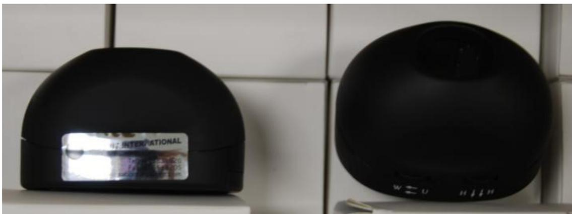
Este sencillo artilugio permite una primera aproximación para la comprobación en documentos de: los fondos de seguridad, dobles plastificados, tintas y plásticos en relieve, marcas al agua, hilos de seguridad, motivos de coincidencia y medidas que incorporen sensibilidad a la iluminación ultravioleta (comprobación de fibrillas, tintas UV, ausencia de blanqueante óptico- ya que uno de los LED es una fuente de luz UV).
