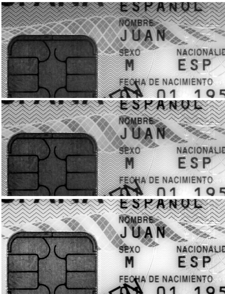
Diferentes respuestas al filtrado mediante infrarrojos a distintas longitudes de onda.
