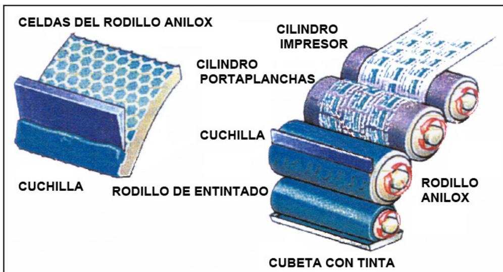
En el esquema anterior una unidad de entintado para un solo color en el que se ha ampliado la estructura del cilindro anilox. Abajo un conjunto completo para imprimir en seis colores con cilindro impresor central.
