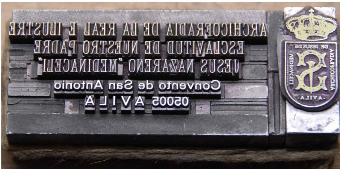
Forma compuesta de caracteres y de una imagen preparada para su colocación en la rama.
