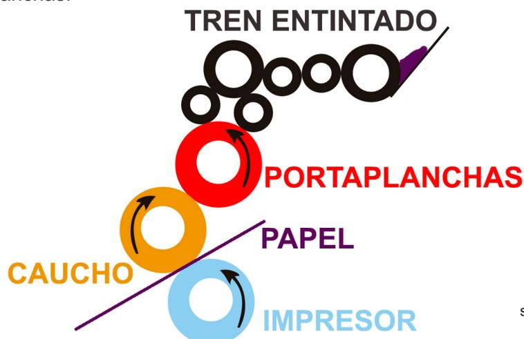
El sistema offset seco es muy similar al húmedo, con diferencias evidentes como son la ausencia de agua y el material de las planchas.
