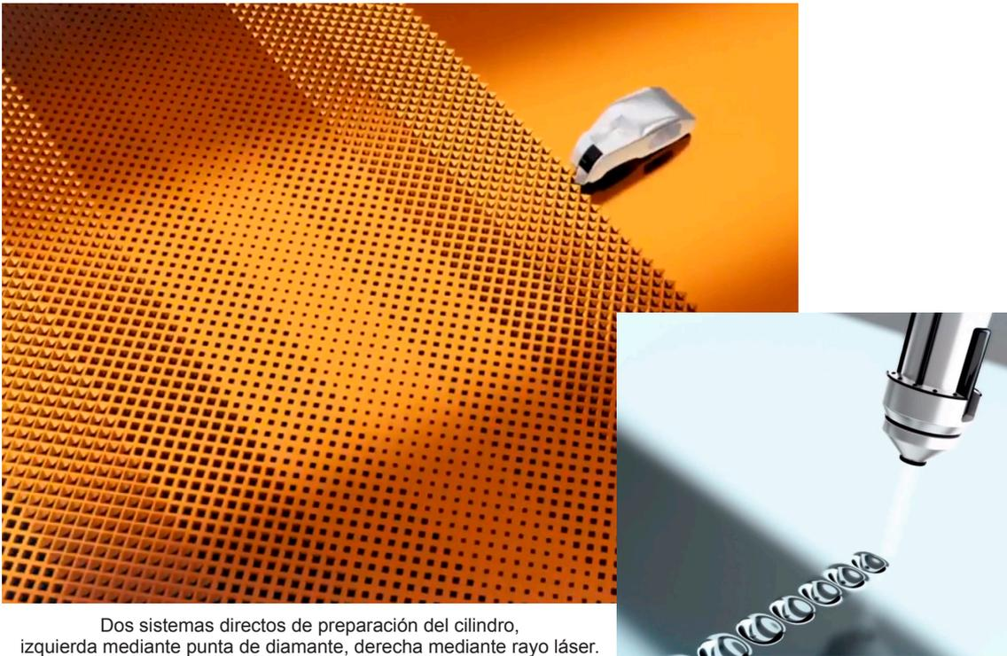
Dos sistemas directos de preparación del cilindro, izquierda mediante punta de diamante, derecha mediante rayo láser.
