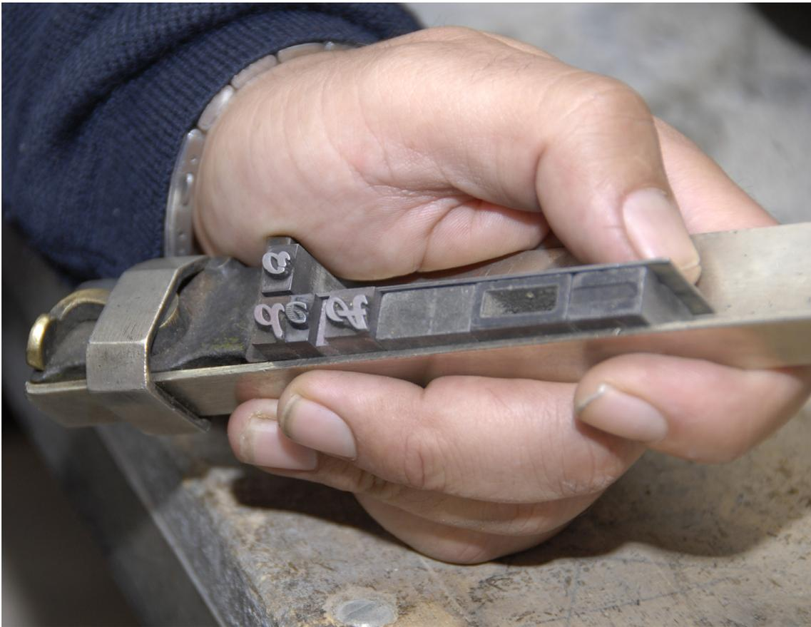
El cajista montando una línea con el componedor.
