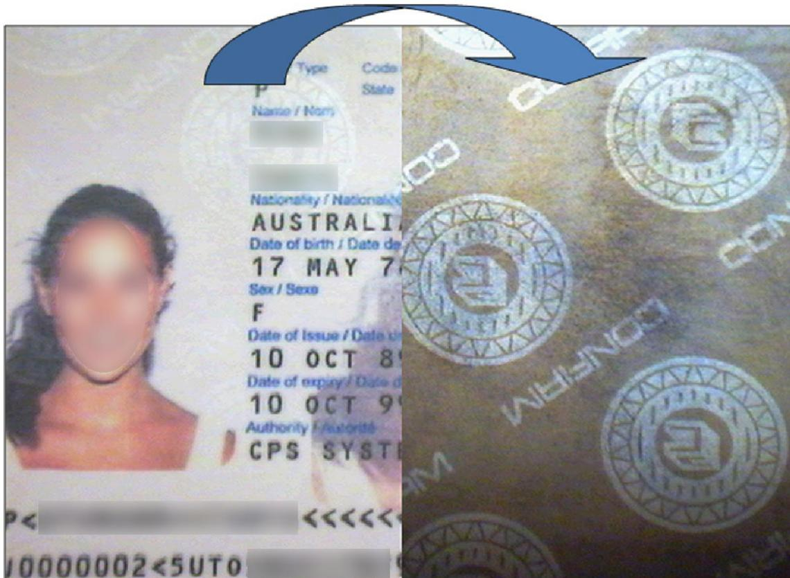
Hoja biográfica de un pasaporte iluminado con luz natural, a la izquierda y el efecto retroflexivo al utilizar una fuente de luz coaxial (Plástico y medida patentada por 3M).
