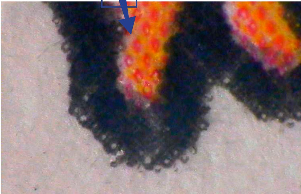
En la siguiente imagen vemos un detalle de una cajetilla de tabaco en la que la observación de la frontera entre las tintas rojas y blancas nos permite localizar las formas geométricas repetitivas, sobre todo a la izquierda en la base horizontal y a la derecha en vertical.
