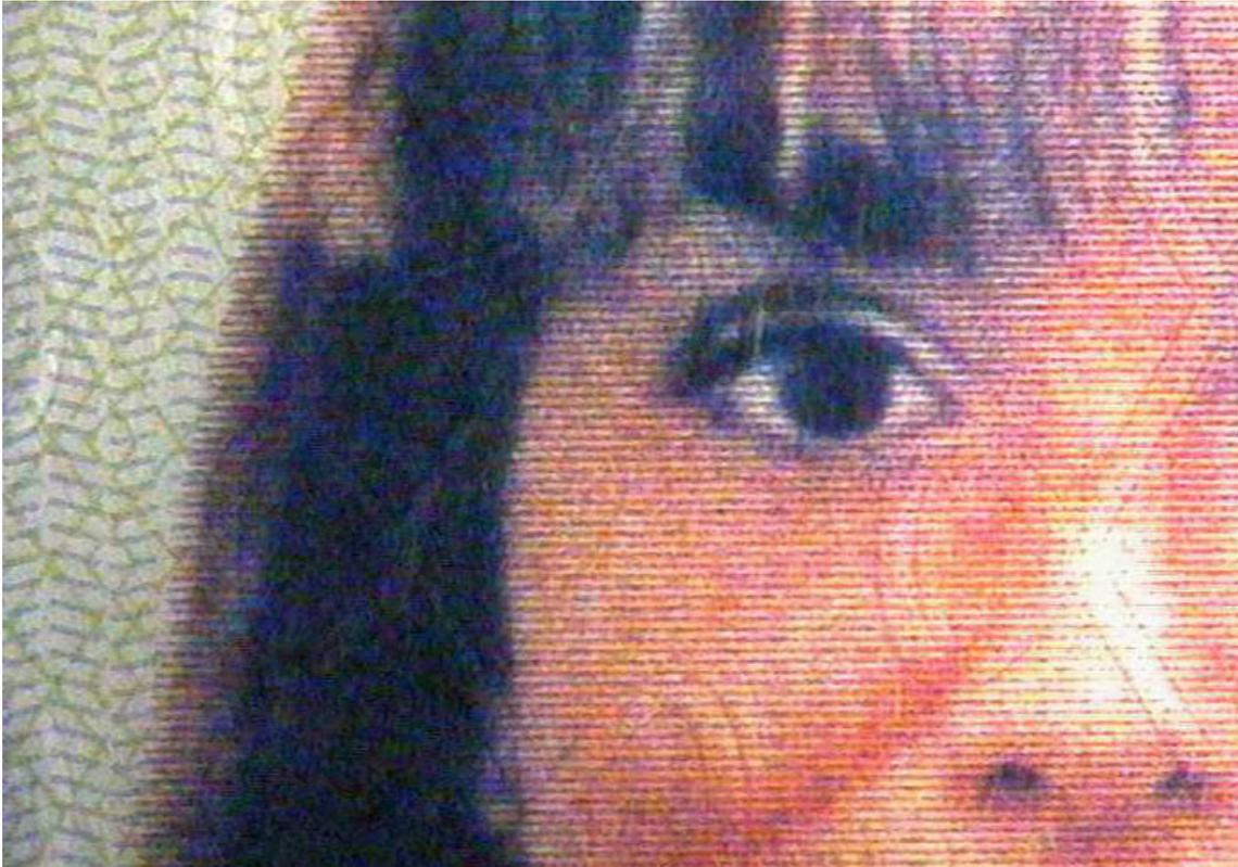
Detalles de la impresión láser en color utilizada para conformar el rostro del titular -se aprecia por debajo la impresión offset de los fondos de seguridad-, las tintas OVI de la leyenda España y la impresión offset del reverso con los caracteres OCR impresos encima mediante sistema de impresión láser.
