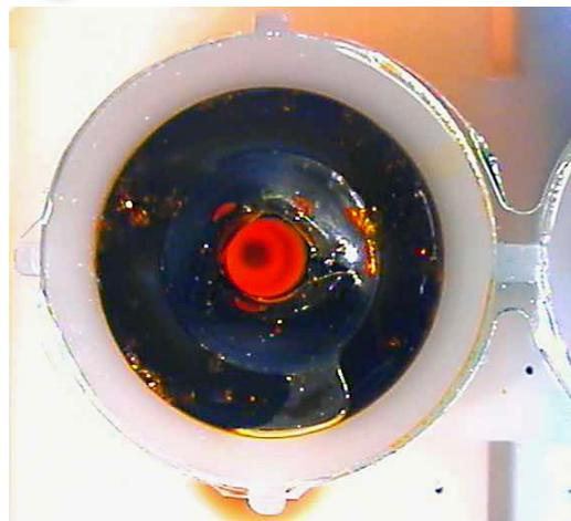
Arriba un cartucho de tinta de una impresora Epson, abajo detalles de las salidas de los tinteros hacia el cabezal.
