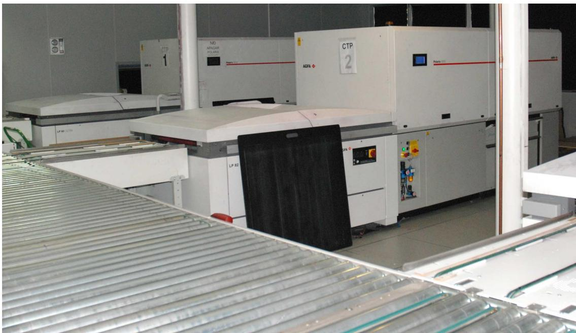
Sistema CtP de Agfa, instalado en la imprenta INCODAVILA, abajo la filmadora láser CtP grabando una plancha (Cortesía de INCODAVILA SA)
