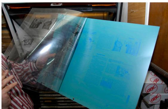
El revelado químico de la plancha, limpiada, aclarada con agua, engomada y secada con aire caliente.
